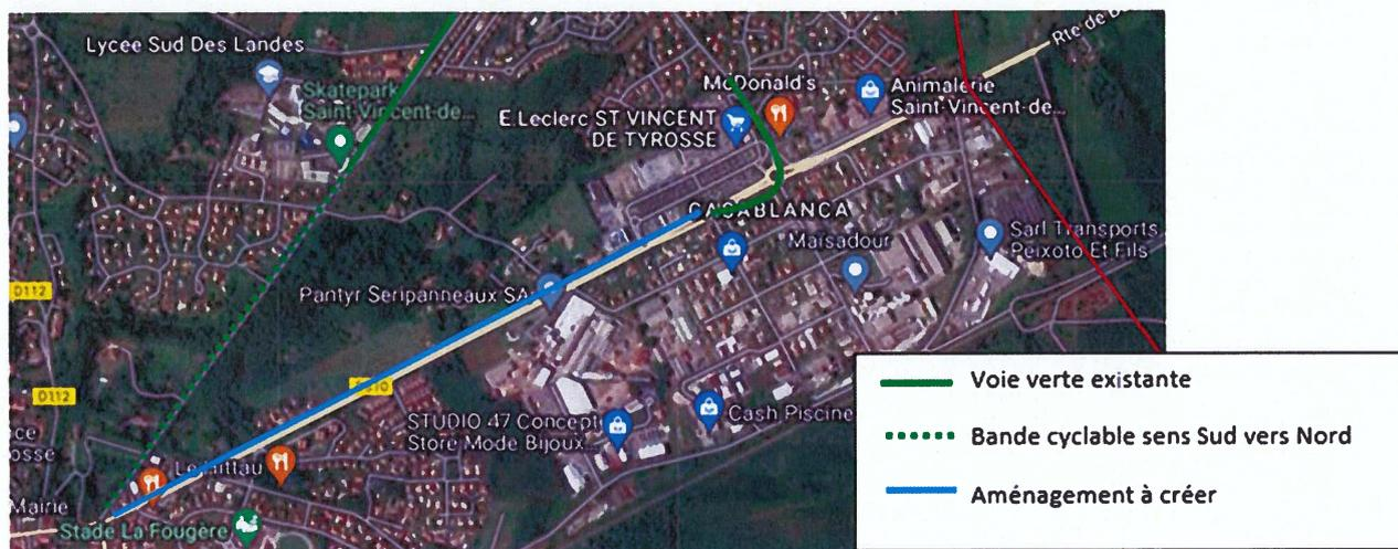
L'aménagement retenu consiste donc à créer un trottoir et une piste cyclable mono directionnelle de part et d'autre de la RD810 assurant la liaison entre les aménagements existants.
