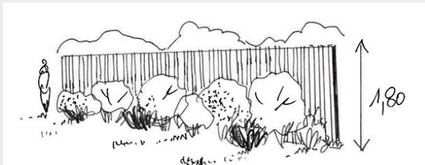
Palissade bois verticale + haie
