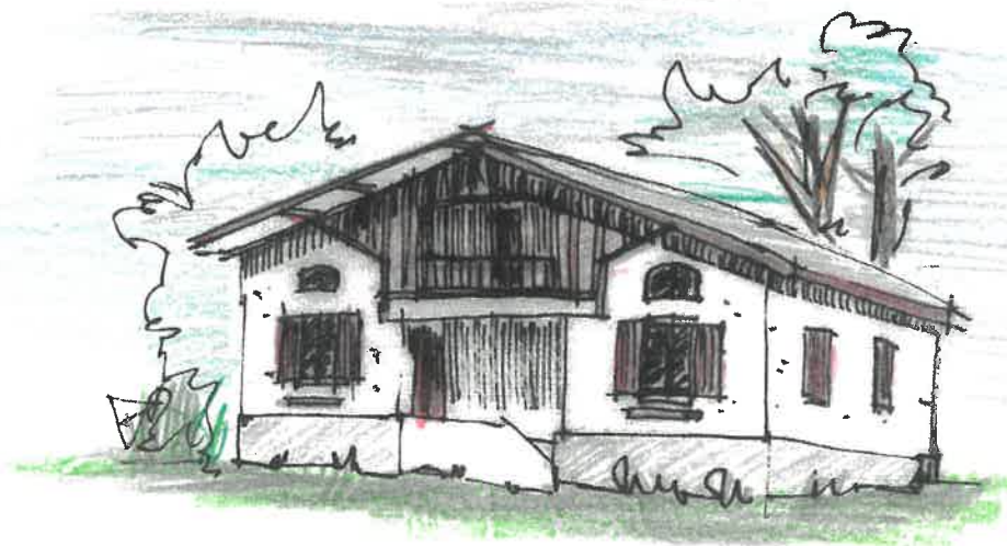
Habitat néo-basque à un étage. Façade pignon entrée architecturée. Symétrie des ouvertures. Mixité des matériaux : enduit, brique, colombage. Mise en peinture des volets, des décors, des bandeaux et des pannes. Toiture 2 pans avec couverture tuile « canal »
