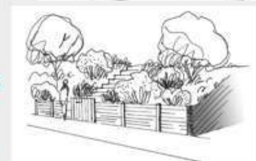
Berlinoise bois en soutènement
