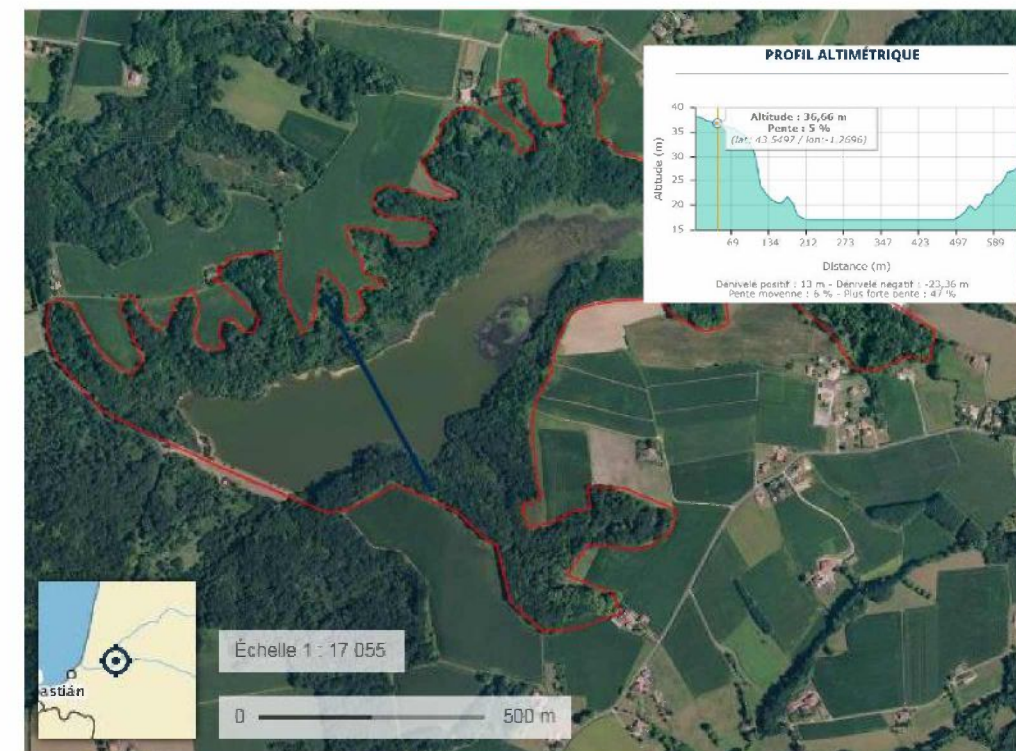
Figure 38: Profil altimétrique dans l'axe Nord-Ouest/Sud-Est
