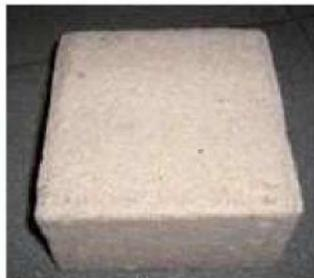
Pavés en béton poreux
