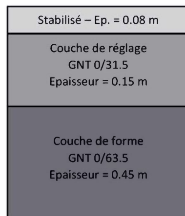
Figure 12 - Profil-type stationnements – Revêtement stabilisé
