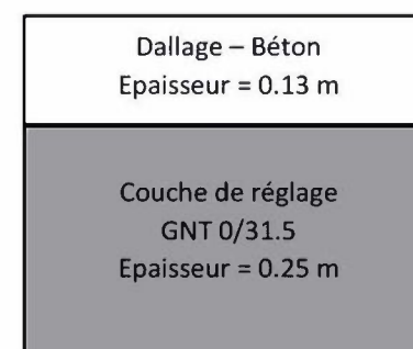
Figure 15 - Profil-type stationnements – Revêtement stabilisé
