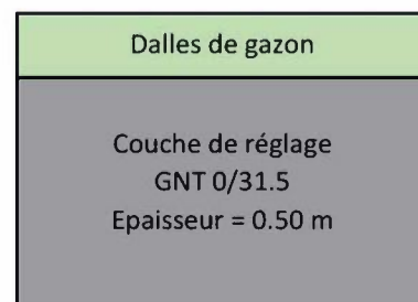
Figure 13 - Profil-type stationnements – Revêtement stabilisé
