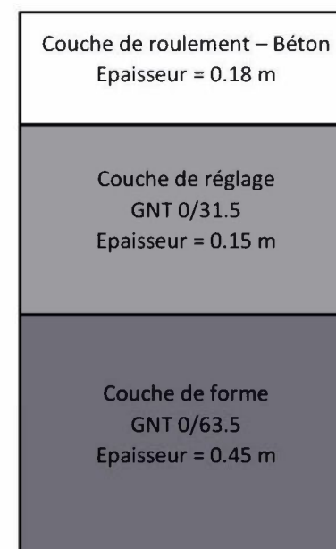
Figure 14 - Profil-type stationnements – Revêtement stabilisé
