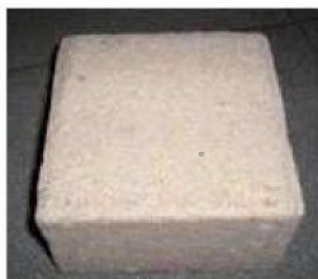
Pavés en béton poreux
