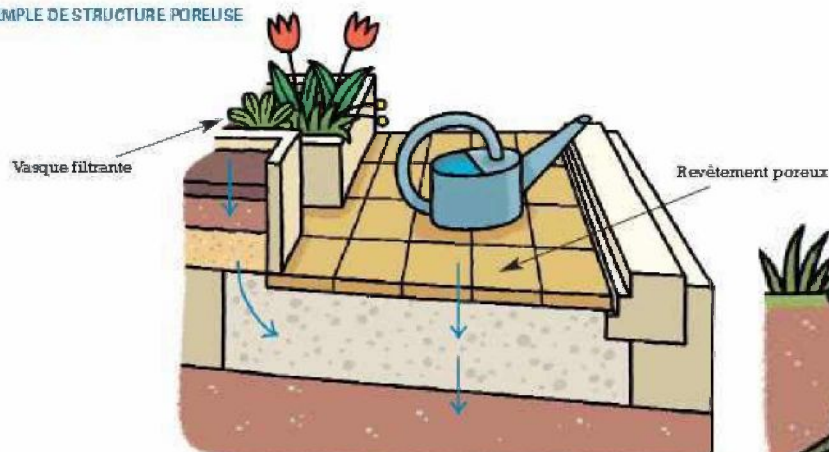
EXEMPLE DE STRUCTURE POREUSE
