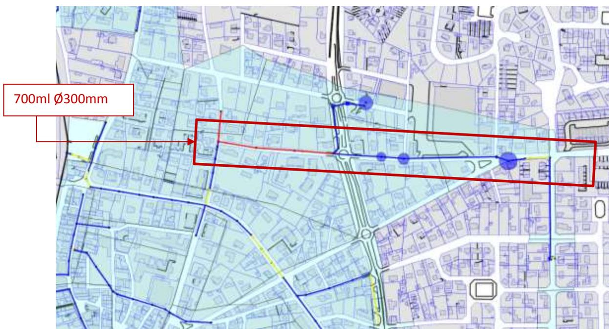
Figure 27 : Avenue des Pins Débordements modélisés – Etat initial P10-2h
