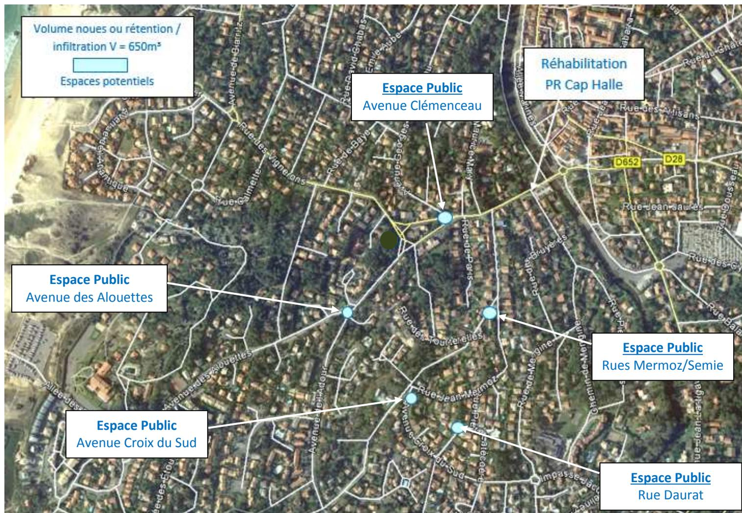
***Espaces Potentiels sur le Bassin Versant Cap Halle pour l'implantation de rétentions/infiltrations***
