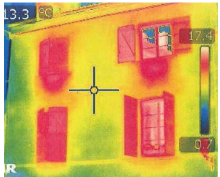
Clichés thermographiques, mise en évidence des déperditions thermiques des fenêtres et de leurs allèges dans le bâti ancien. L'allège est un poste de déperdition important dans le mur à isoler et à traiter. Source EcoFébus Habitat.
